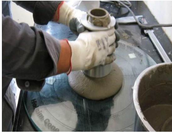
Fotografía 4.20 Prueba de flujo con HolcimCone
