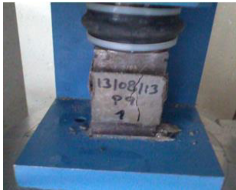
Fotografía 4.8 Rotura de cubo de mortero
