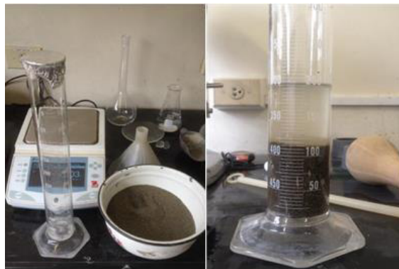
Fotografía 4.10 Mezcla de arena con hidróxido
