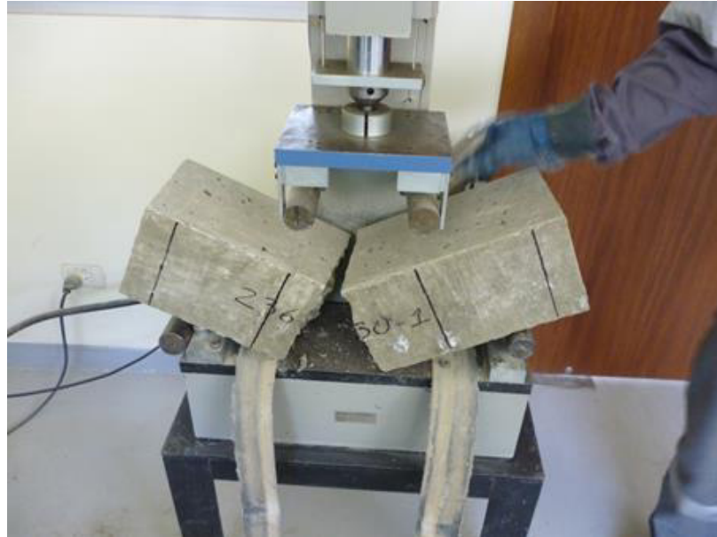
Fotografía 7.12 Rotura de los agregados y no desprendimiento
