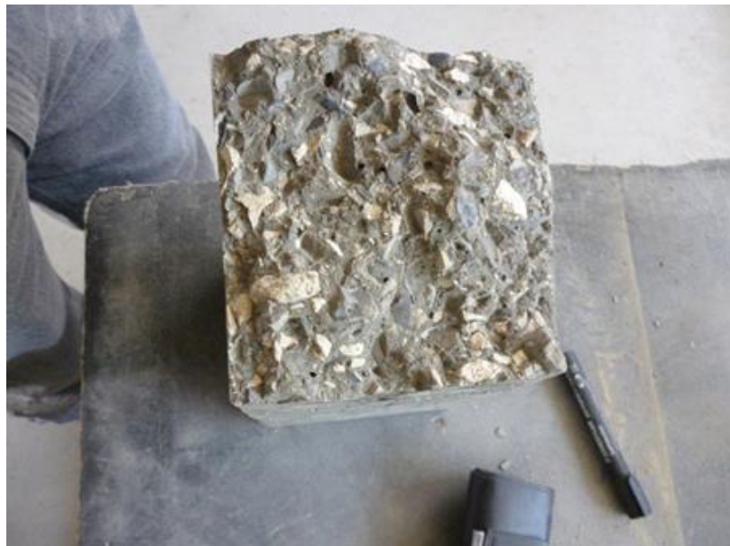
Fotografía 7.12 Rotura de los agregados y no desprendimiento
