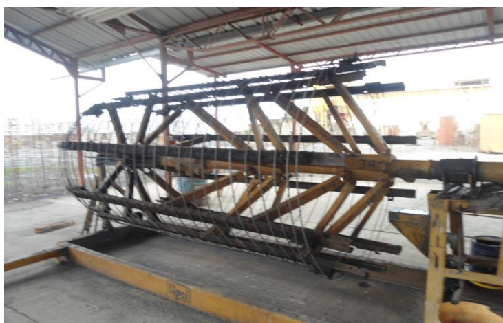
Figura 1.2 Proceso de rolado de la estructura (canasta) del tubo de 60"
