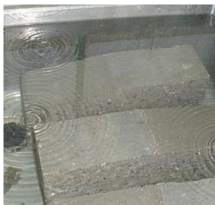
Figura 1.9 Ensayo de absorción realizado al hormigón de los tubos de 60"
