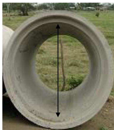
Figura 2.9 Diámetro interior de la tubería
