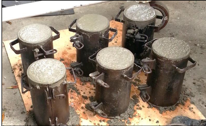
Figura 5.28. Probetas de hormigón para pruebas de resistencia a la compresión.
