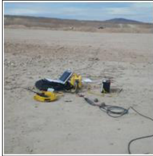
Figura 2.3. Sismógrafo tendido en el terreno.
