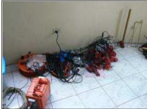
Figura 3.3. Sismógrafo Geotrix ES-3000 con 24 geófonos.
