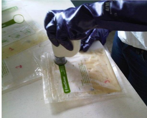
**FIGURA 2. 2** Sellado al vacío del látex
