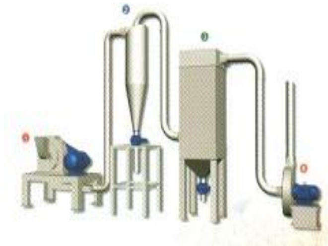
FIGURA 3.7 ESQUEMA DE SISTEMA DESEMPOLVADO
