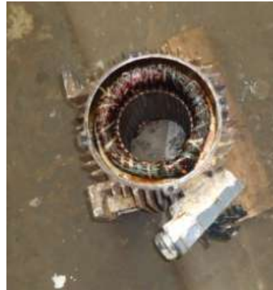
Figura 7.5 Motor desarmado para reparar devanado
