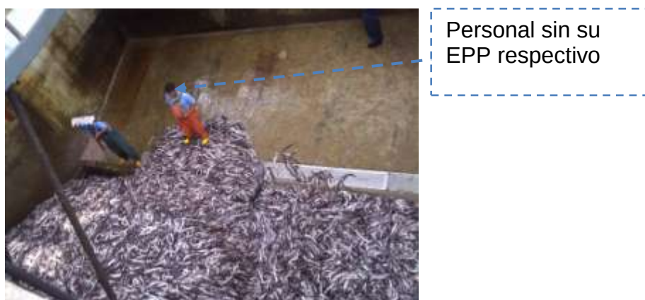
Figura 3.16 Falta de control de EPP al personal
