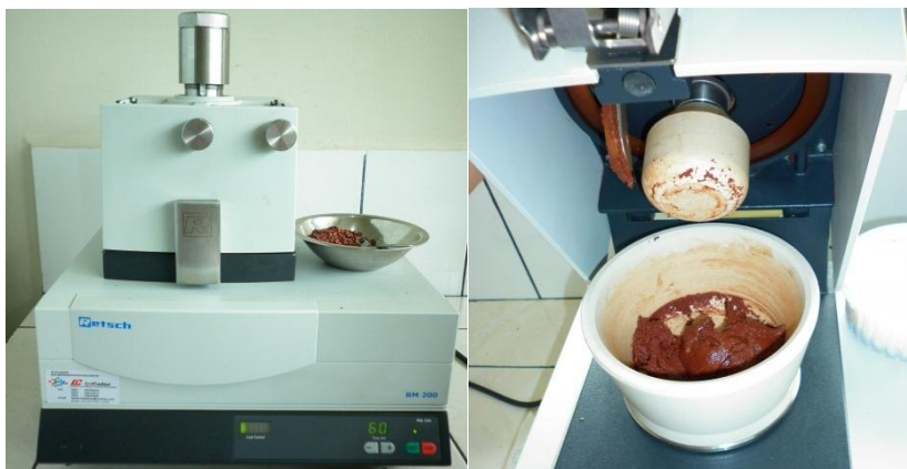
FIGURA 2. 9. MOLIENDA DE LOS NIBS DE CACAO EN UN MOLINO DE MORTERO
