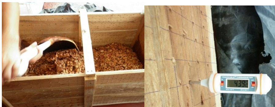
FIGURA 2. 2. REMOCIÓN CON PALA PLÁSTICA Y TOMA DE TEMPERATURA CON TERMÓMETRO DIGITAL
