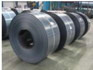
**FIGURA # 15** FLEJE LAMINADO CALIENTE
