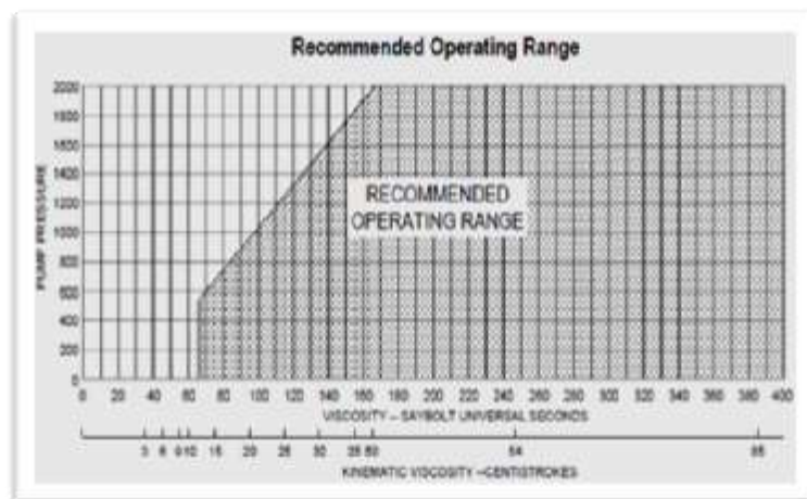
FIGURA 2.17. RANGO DE OPERACIÓN DE LAS BOMBAS
