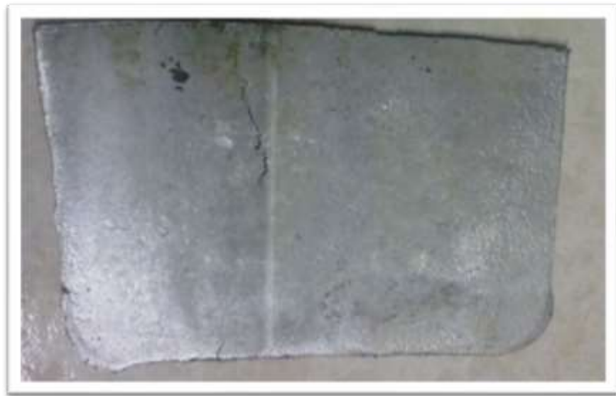
FIGURA 1.1. ENSAYO DE LAMINACIÓN CON ALUMINIO MUESTRA DESPERFECTOS POR FALTA DE ALINEACIÓN DE RODILLOS.
