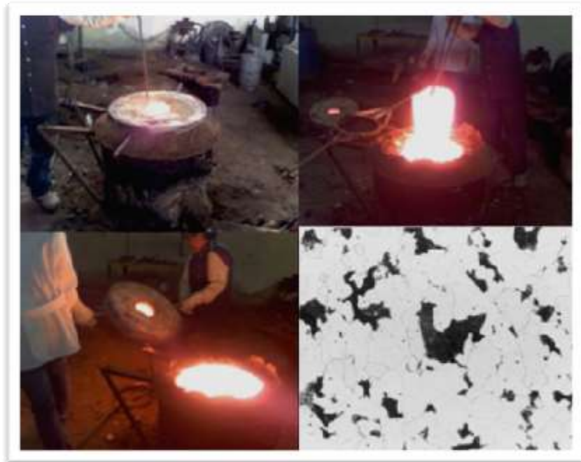
FIGURA 2.25 PROCESO DE OBTENCIÓN DEL ACERO SAE 1020 Y MICRO ESTRUCTURA
