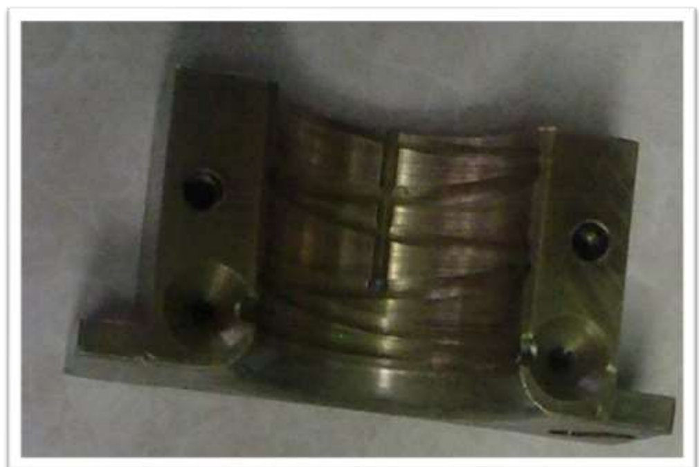
FIGURA 1.3. COJINETE DE DESLIZAMIENTO CON ROSCAS DEFORMADAS.
