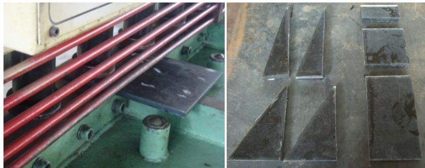
FIGURA 2.19. CONSTRUCCIÓN DE PLACAS Y CARTELAS.
