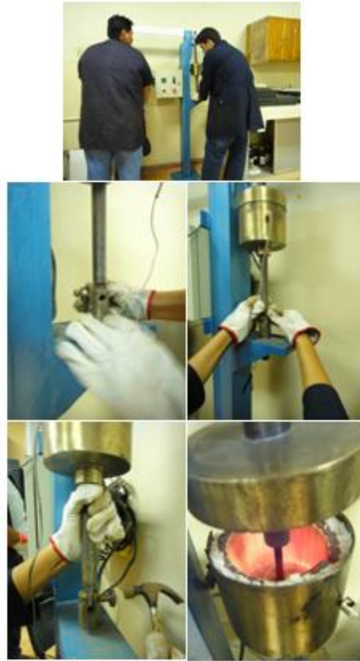
FIGURA 3.6. SUJECION DE LAS BARRAS A LA BANCADA Y ENCENDIDO DEL HORNO.
