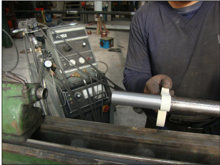
Figura 3.12: Protección del área adyacente a ser rociada
