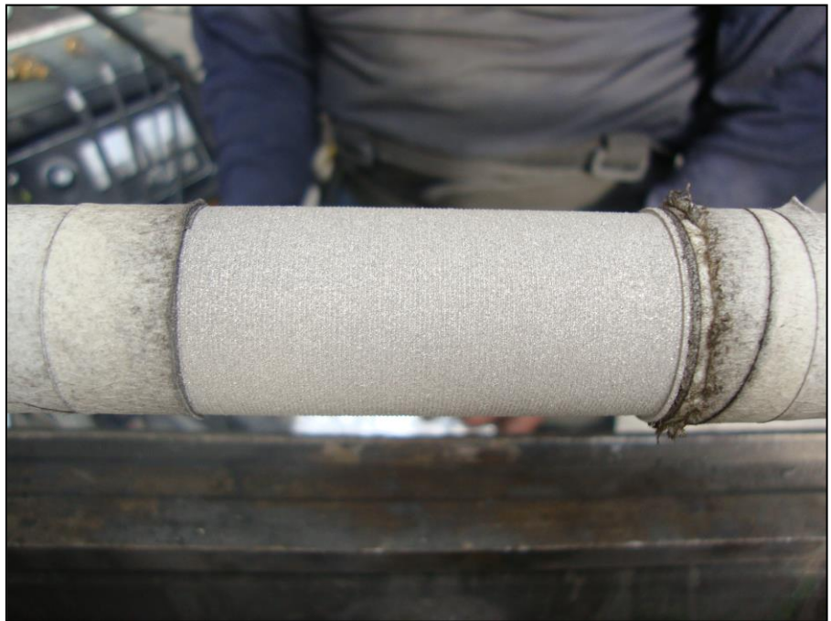
Figura 3.14: Estado del eje luego de aplicado el alambre base
