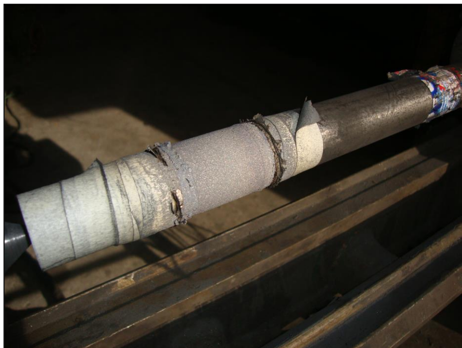
Figura 3.16: Estado del eje luego de aplicado el alambre final
