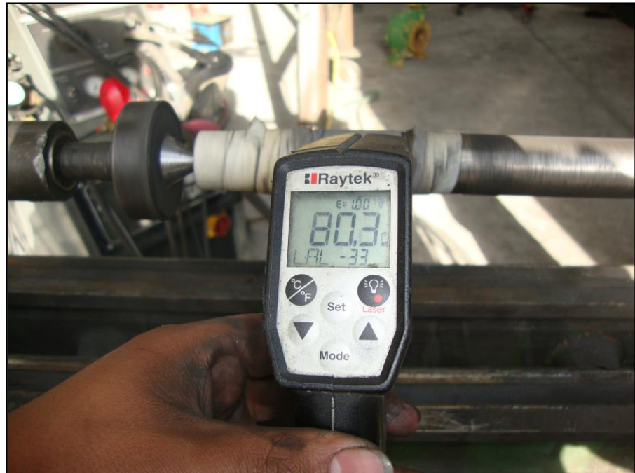
Figura 3.17: Control de temperatura durante el rociado
