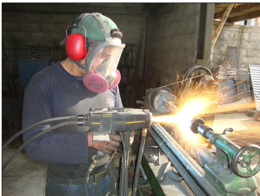
Figura 3.15: Aplicación del alambre final 60T
