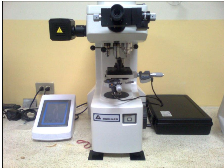
Figura 3.5: Equipo utilizado para medir la dureza
