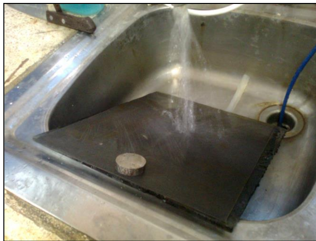
Figura 3.1: Muestra sumergida en agua para el desbaste
