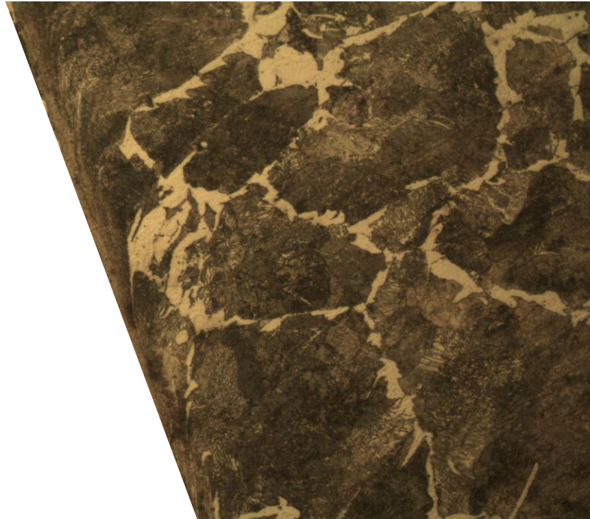
Figura 3.4: Estructura Metalográfica Pre-Metalización de la sección transversal del eje a 500x
