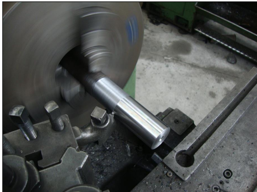
Figura 3.10: Inicio del maquinado de rosca en el eje
