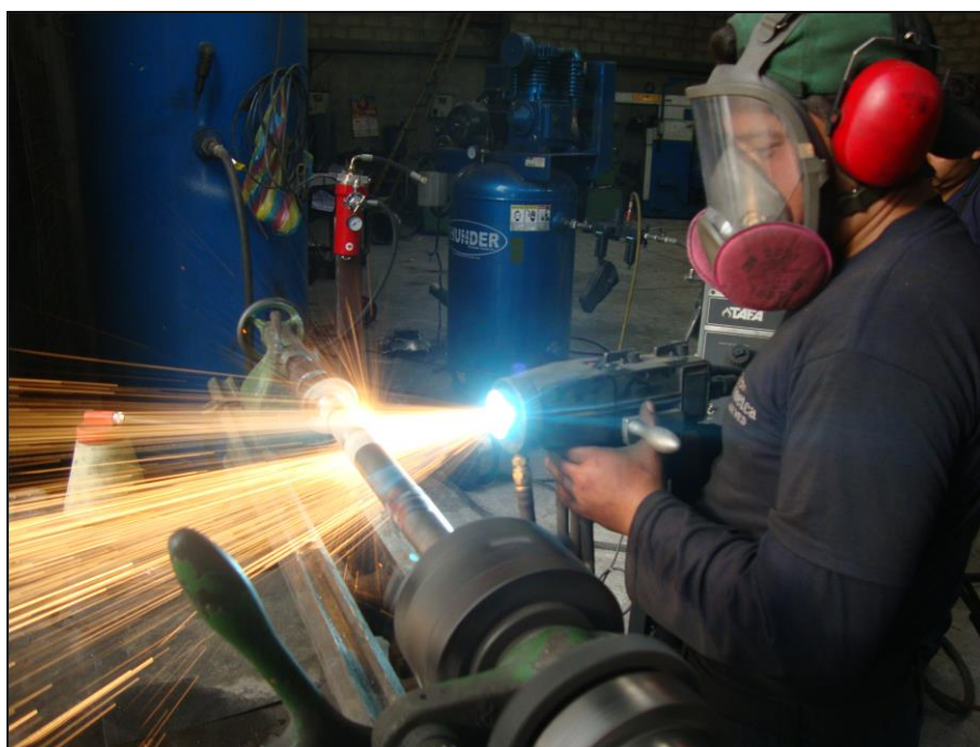
Figura 3.13: Aplicación del alambre base BOND ARC 75B
