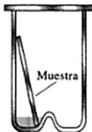
**Figura 2.4 Correcta colocación de placas**
