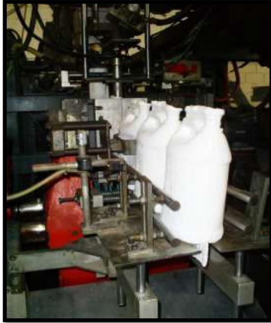
**FIGURA 1.10: ENVASES POR EXTRUSIÓN SOPLADO**
