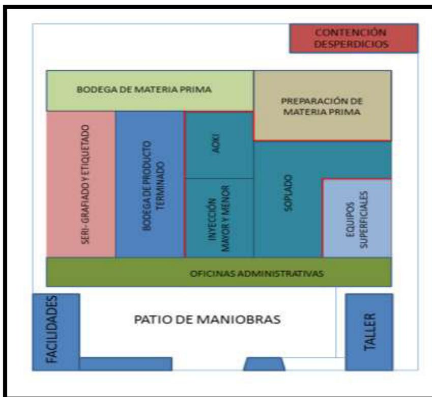
**FIGURA 1.1: ESQUEMA Y DIVISIÓN DE LA EMPRESA Y SUS ÁREAS.**
