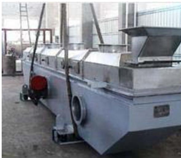
**FIGURA 4.8 SECADOR LECHO FLUIDIZADO DRH-6S**
