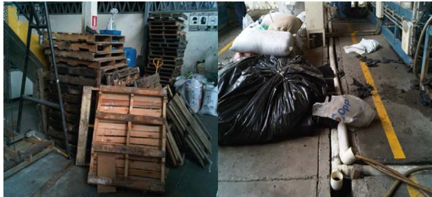
FIGURA 4.6 DESORDEN Y MALA UBICACIÓN DE MATERIALES
