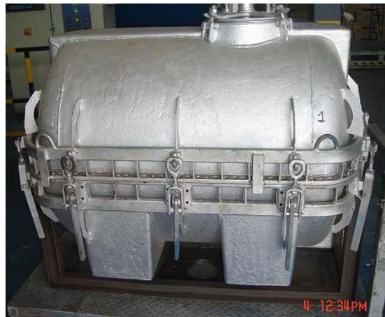
**FIGURA 3.4 MOLDE DE ROTOMOLDEO**
