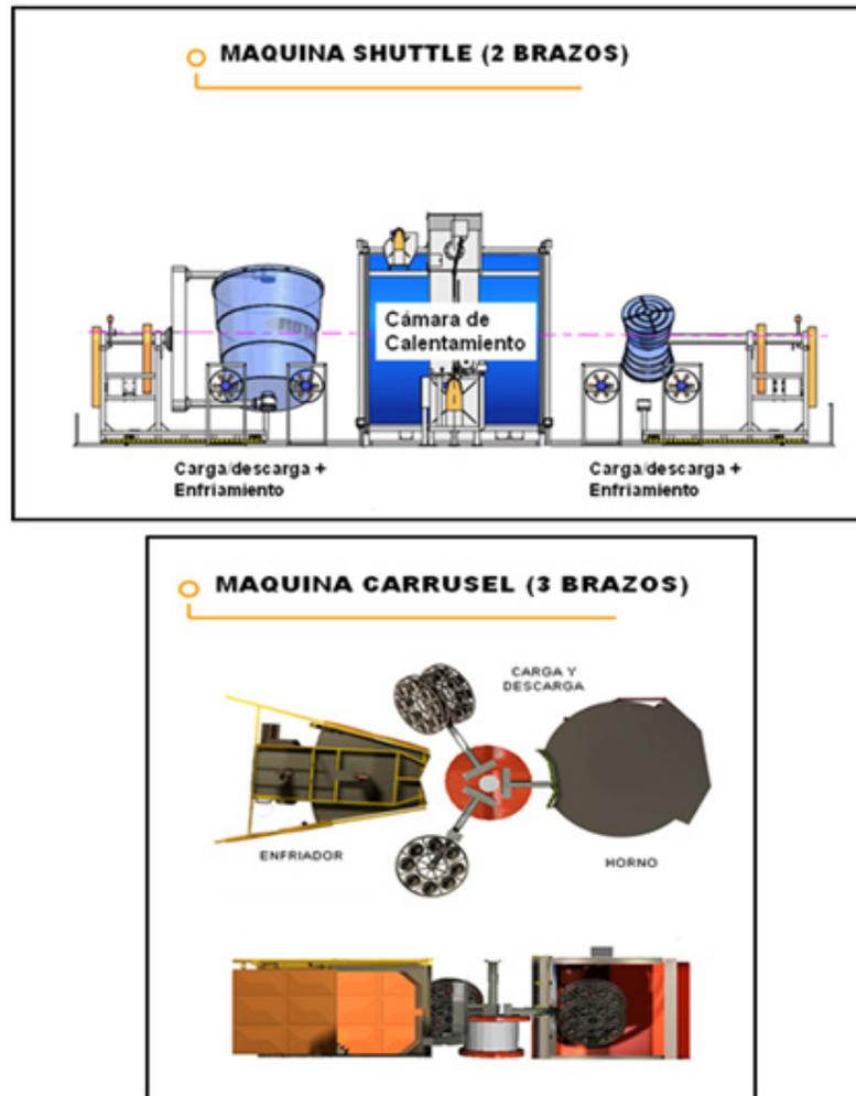
**FIGURA 3.5 ESQUEMA DE MAQUINARIAS DE ROTOMOLDEO**
