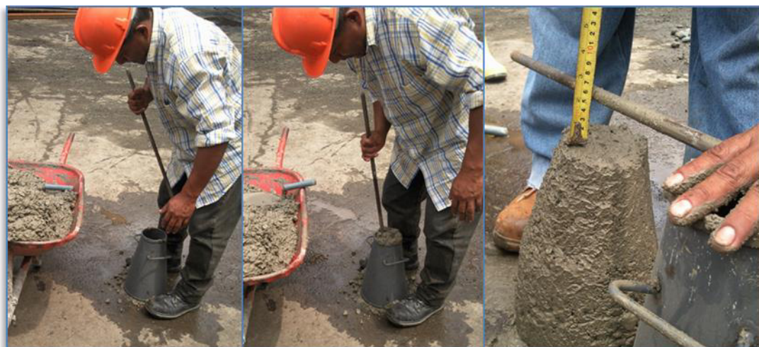
FIGURA 4.17. PRUEBA DEL CONO DE ABRAMS APLICADO AL HORMIGÓN.
