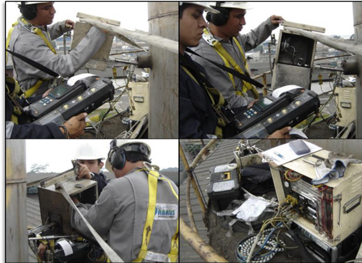
FIGURA 5.2. TÉCNICOS DE ABRUS CIA. LTDA. DURANTE MONITOREO DE GASES DE COMBUSTIÓN DE LA CALDERA #8.
