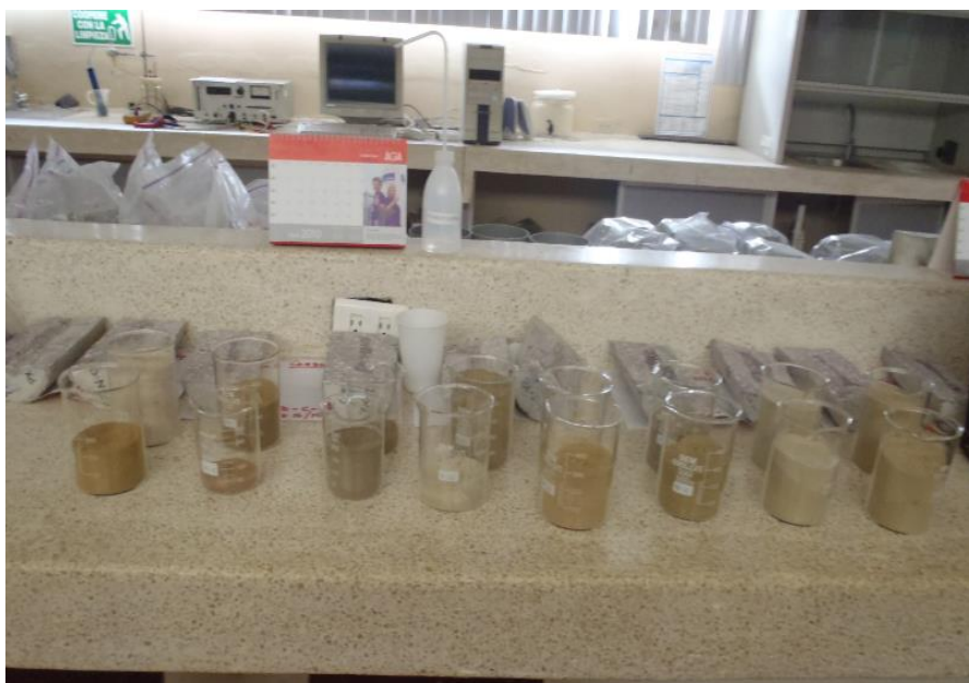
FOTO 2.1 PREPARACIÓN DE LAS CATORCE MUESTRAS DE ARCILLA PARA LA REALIZACIÓN DE SUS RESPECTIVOS ANÁLISIS
