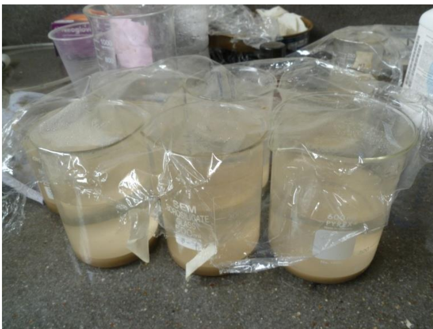
FOTO2.3 LAVADO DE LAS MUESTRAS DE ARCILLA DESPUES DE LA ELIMINACION DE MATERIA ORGANICA Y CARBONATOS
