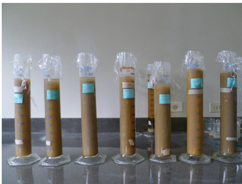
FOTO 2.4 SEDIMENTACIÓN DE LAS MUESTRAS DE ARCILLA
