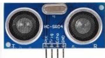
Figura 2. Sensor ultrasónico HC-SR04 [2].
