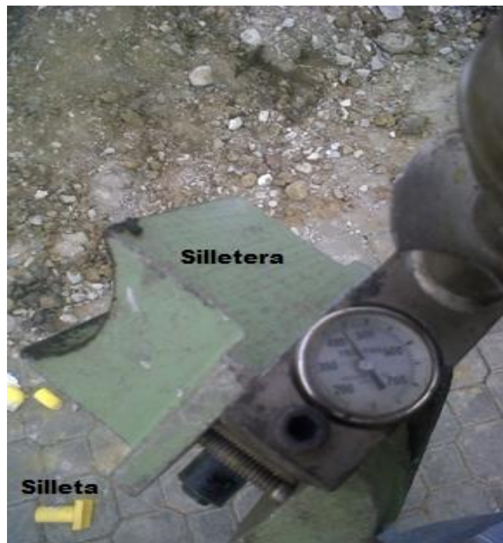
FIGURA 10 : PLANCHA CALENTADORA CON TERMÓMETRO ADAPTADO
