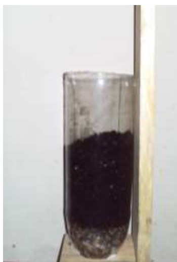
Figura 3.6 Filtro de Carbón Activado.
