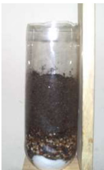
Figura 3.5 Filtro de Arena.
