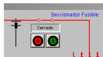
FIGURA 5.5. BOTONERA DE FUSIBLE A.T. HABILITADA
