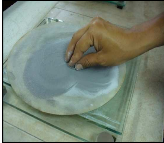
FIGURA 3.11. PULIDO CON PASTA DE DIAMANTE
