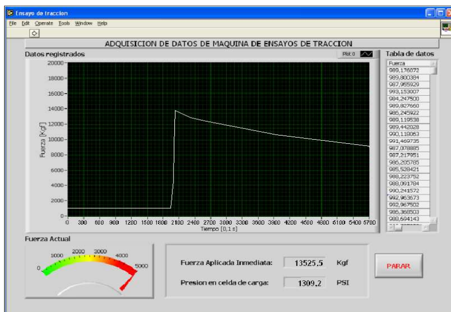
FIGURA 3.7. CURVA FUERZA VS TIEMPO, PROBETA 4 EXTRUIDA
