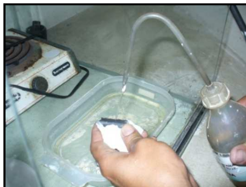
FIGURA 3.12. ATAQUE QUÍMICO CON REACTIVO.
