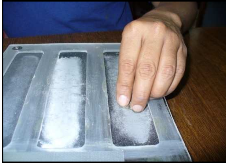
FIGURA 3.10. MESA DE PULIDO CON BASE DE VIDRIO Y CANALES DE ACRÍLICO.
