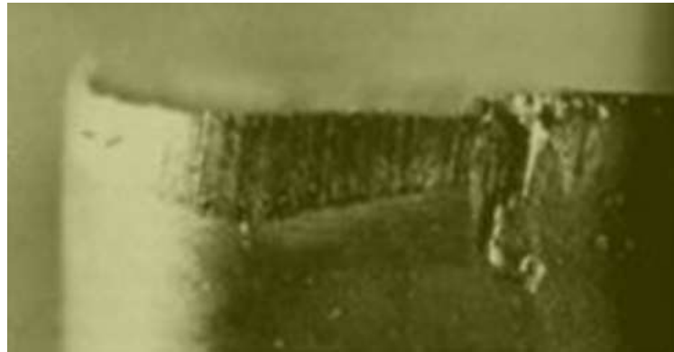
Figura 2.7 Desgaste en el flanco.
