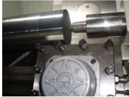
Figura 2.10 Fijación de la herramienta entre puntos.
