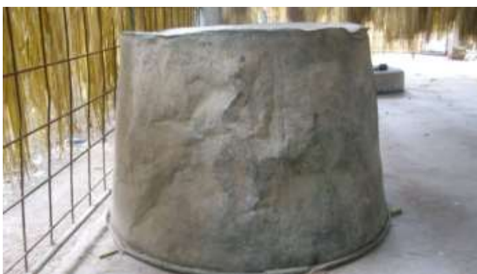
Caldero para decoloración de la paja toquilla
