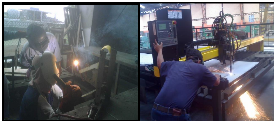
FIGURA 1.2. FORMACIÓN DE HUMOS METÁLICOS Y GASES POR PROCESOS DE SOLDADURA AL ARCO.
