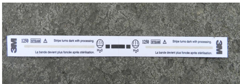
FIGURA 2.8 INDICADOR QUÍMICO A TRAVÉS DE CAMBIO DE COLOR.
