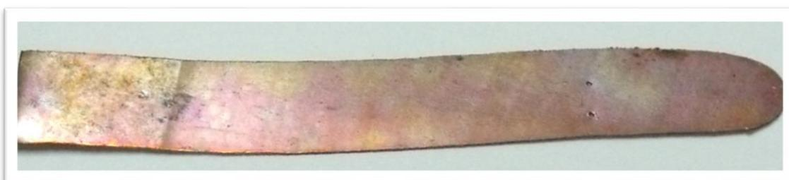
**Figura 2.4.** Prueba 9.1, limpieza de la lámina de cobre con dos pases de vapor.
