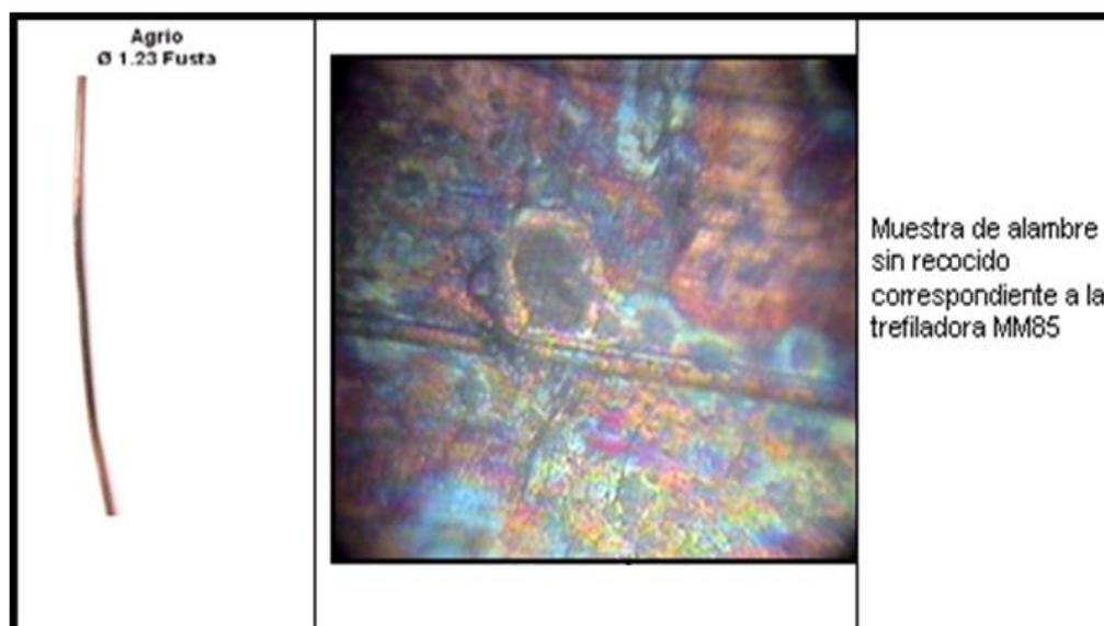
**Figura 1.12.** Alambre y Micrografía de muestra agria
