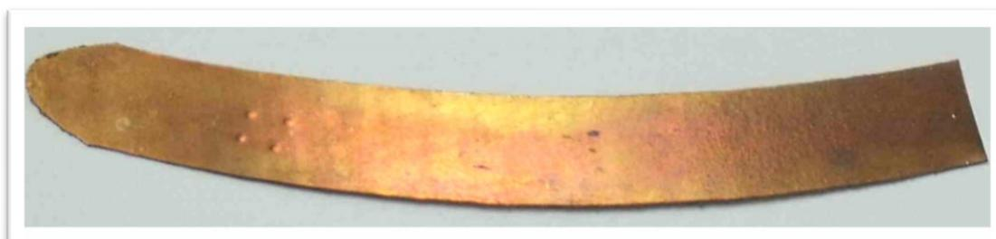
**Figura 2.5.** Prueba 9.2, limpieza de la lámina de cobre con cuatro pases de vapor.
