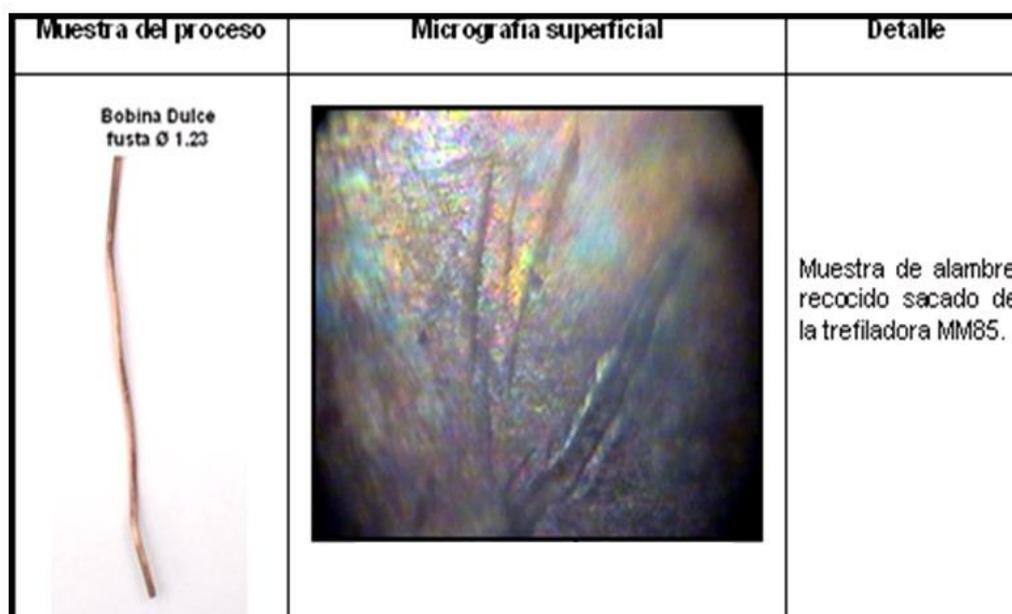
**Figura 1.11.** Alambre y Micrografía de muestra recocida
