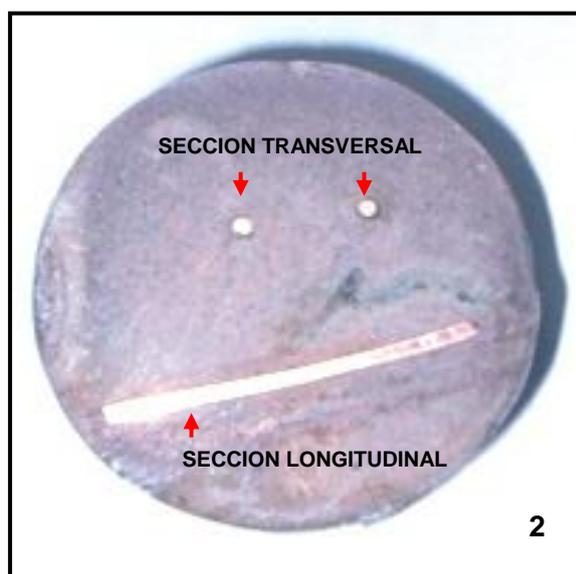
**Figura 1.15.** Probeta 2 de cobre trefilada hasta la fusta 1.25 en estado agrio
