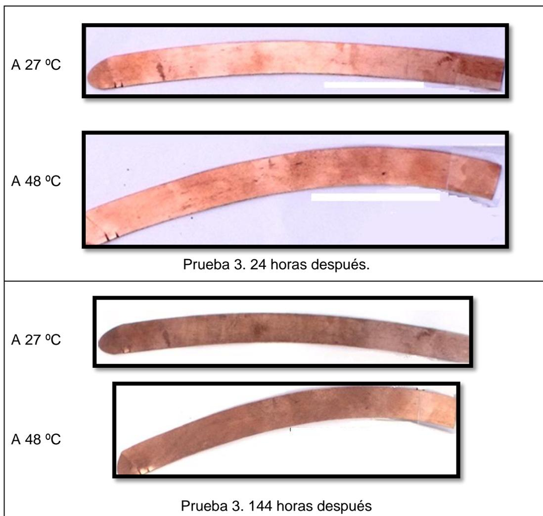
**Figura 2.1.** Aspecto superficial después de las 24 y 144 horas del ensayo de laminación de la Prueba 3.
