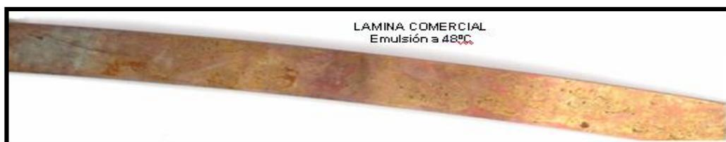
Para la prueba 2 se empleó también dos tipos de probetas, una procedente de la planta y la otra de una platina de cobre comercial, como lubricante la emulsión de la máquina MM85 con temperatura de 48 °C, aplicada de forma continua durante la laminación; al finalizar las probetas se recocieron a 200 °C por 30 minutos; los resultados para esta prueba se los presenta en la tabla 12.
