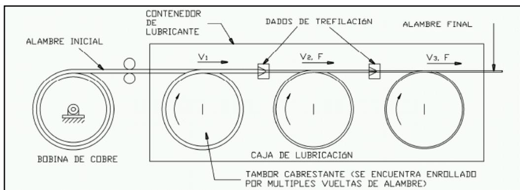
**Figura 1.2.** Esquema de la trefilación de alambres
