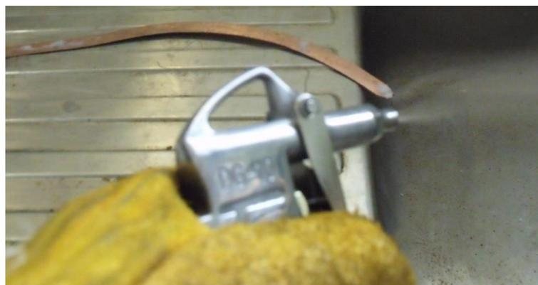
**Figura 2.3.** Aplicación del vapor mediante rociador.
