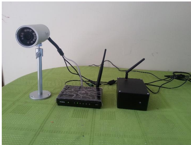
Figura N5 Cámara Ip.
