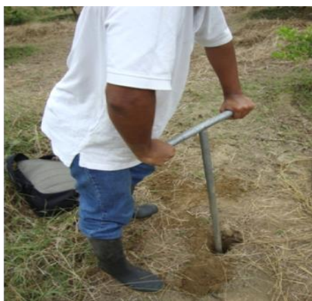
Figura 3.4 Barrenación en la cuenca del río Valdivia.
