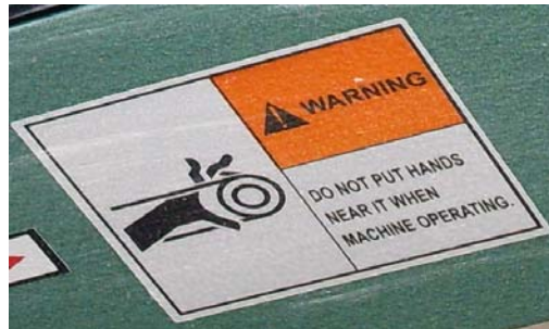
FIGURA 5.2 Peligro Cuidado con las poleas.
