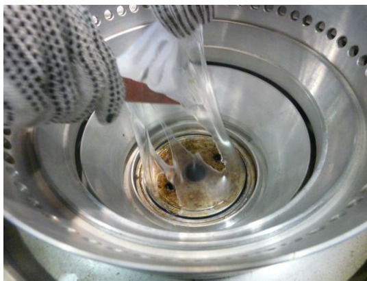
FIGURA 3.45 Segunda salida de producto un tanto defectuosa
