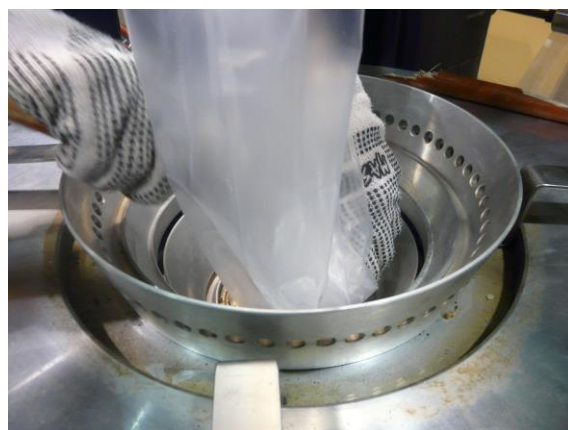
FIGURA 3.49 Levantando la película
