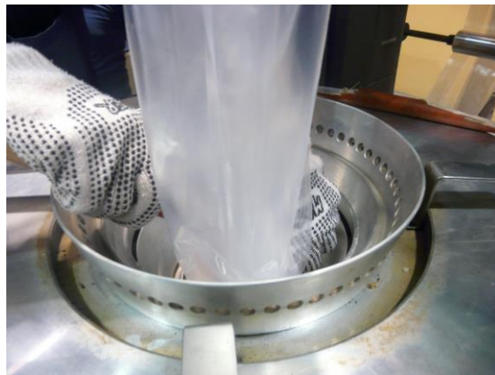
FIGURA 3.48 Uniendo el producto con la película guía
