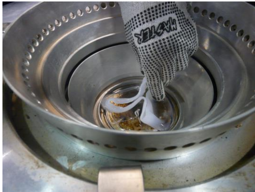
FIGURA 3.44 Eliminación total de rebaba
