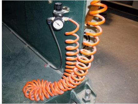
FIGURA 3.40 Aire a Presión para Bobinador
