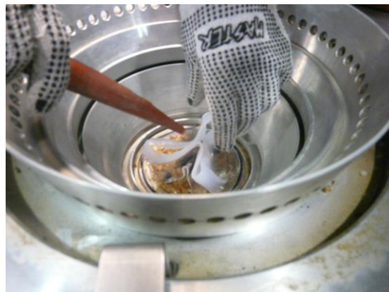
FIGURA 3.43 Limpiando totalmente la boquilla del dado
