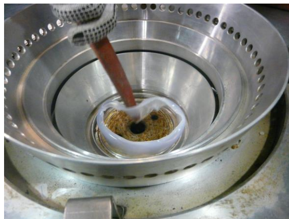
FIGURA 3.42 Forma correcta de eliminar la rebaba
