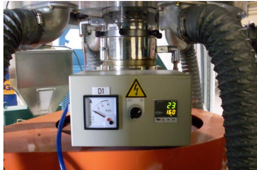
FIGURA 3.25 Resistencias, Termocuplas, Monitores
