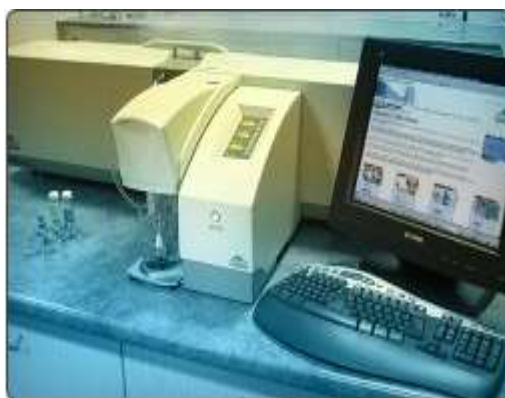
FIGURA 3.1 ANALIZADOR DE TAMAÑO DE PARTÍCULAS
