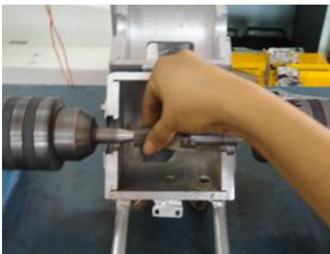
FIGURA 3.19: PROCESO DE LIJADO DE PROBETAS.
