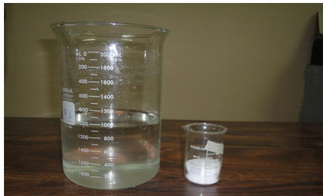
FIGURA 3.15: PREPARACIÓN DE LA SOLUCIÓN SALINA [5%NaCl].
