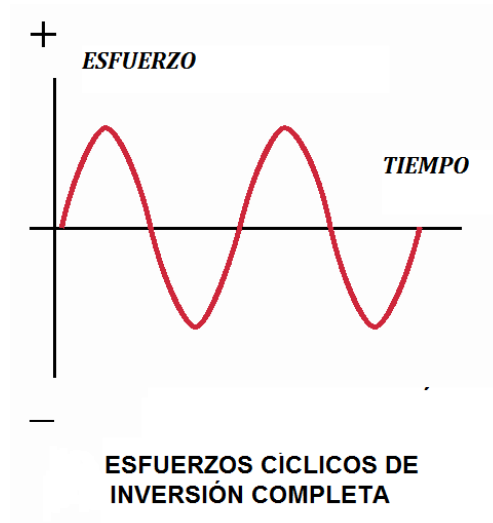
FIGURA 1.12 COMPORTAMIENTO SINUSOIDAL DEL ESFUERZO
