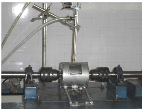
FIGURA 3.20: MONTAJE DE LA PROBETA EN MÁQUINA DE ENSAYOS
