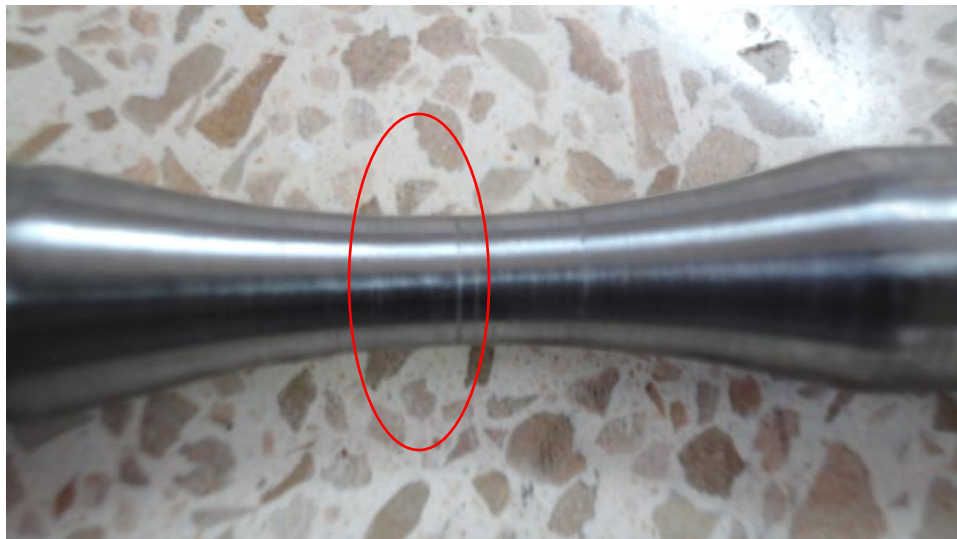
FIGURA 3.8 PROBETA RECHAZADA PARA EL ENSAYO
