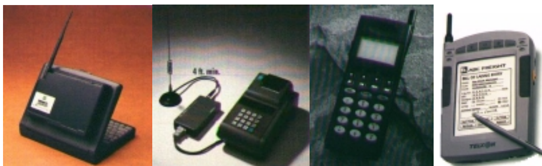
Fig. 8 Algunos tipos de MES. De izq. a der.: Computador portátil con módem CDPD, Punto de Venta con módem CDPD, Teléfono Inteligente y Capturador de Datos.
