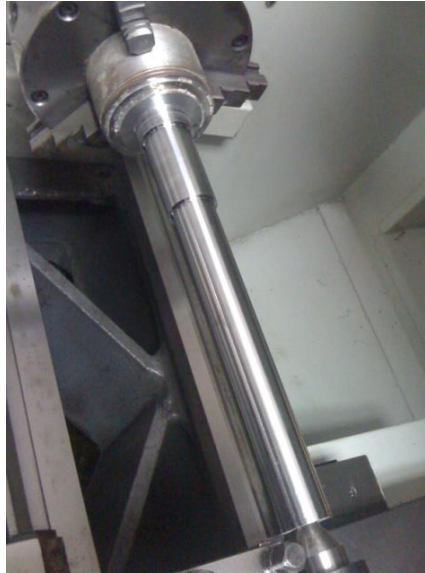
Fig.4.2 BUEN ACABADO SUPERFICIAL
