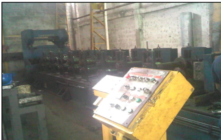
FIGURA 3.7 PERFILADO DE CORREAS
