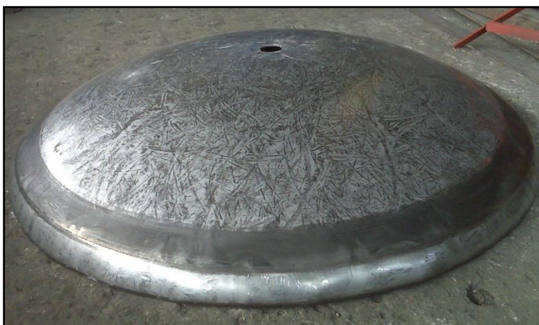
FIGURA 3.12: TAPA BOMBEADA Y REBORDEADA.
