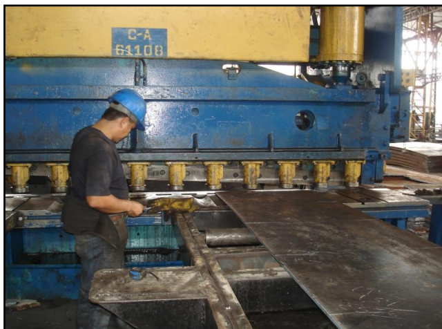
FIGURA 3.2: GUILLOTINA PESADA, CALIBRACIÓN PARA CORTE 10MM.
