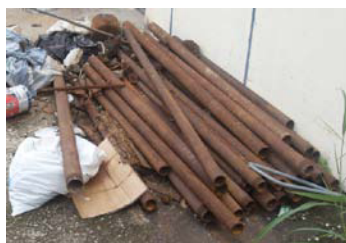
FIGURA 1.21. TUBOS DE PERFORACIÓN DESECHADOS
