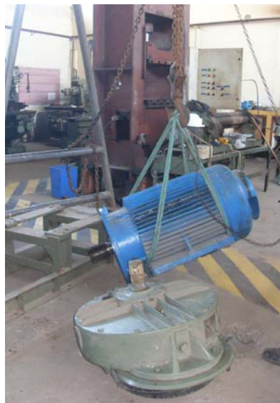
FIGURA 2.36. DESMONTAJE DE LAS PARTES DEL MOTO-REDUCTOR
