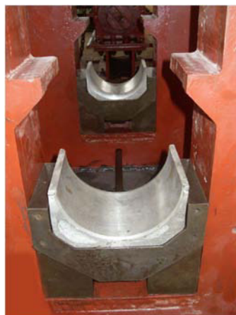
FIGURA 2.7. MONTAJE DE COJINETES
