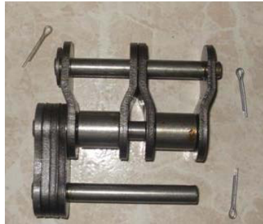
FIGURA 2.24. MUESTRA DE LA CADENA N° 120, SEGÚN MARTIN.
