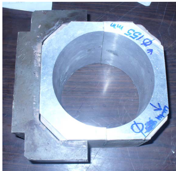
FIGURA 1.32. MODELOS FUNDIDOS EN ALUMINIO
