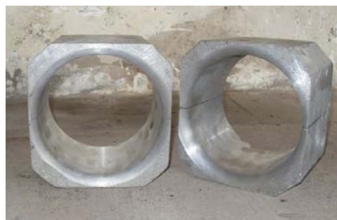
FIGURA 2.5. COJINETES ANTES Y DESPUES DE SER MAQUINADOS
