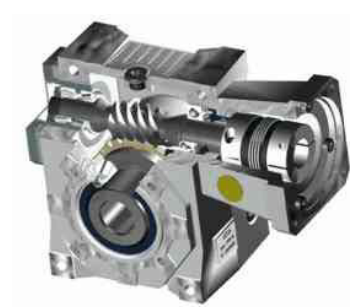
FIGURA 2.11. REDUCTOR TIPO CORONA-SINFÍN CON BRIDA (O CAMPANA) PARA SERVOMOTOR Y ACOUPLE TIPO FUELLE DE ALTA RIGIDEZ TORSIONAL. CORTESÍA DE SIPCO
