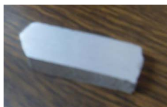
FIGURA 2.3.B) PROBETA PARA ENSAYO DE DUREZA
