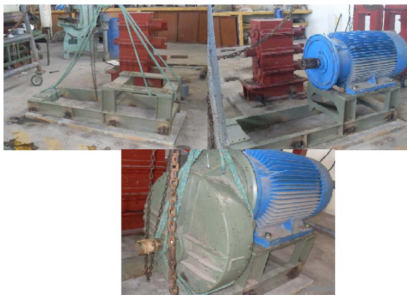
FIGURA 2.37. MONTAJE DEL MOTO-REDUCTOR
