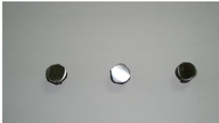
Figura 2.6 Probetas de Acero ASTM A42 para Ensayos Electroquímicos.
