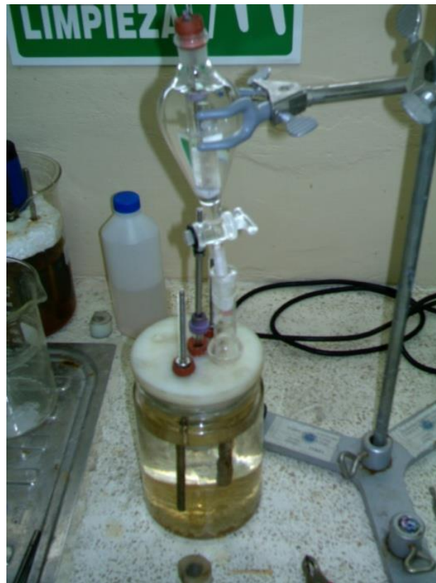
Figura 2.8 Celda de Polarización Electroquímica (Diseño Terminado).
