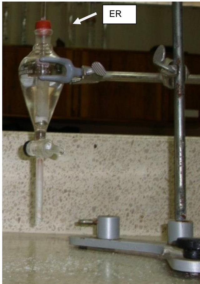
Figura 2.10 Electrodo de Referencia de Calomel Saturado (Diseño Terminado).
