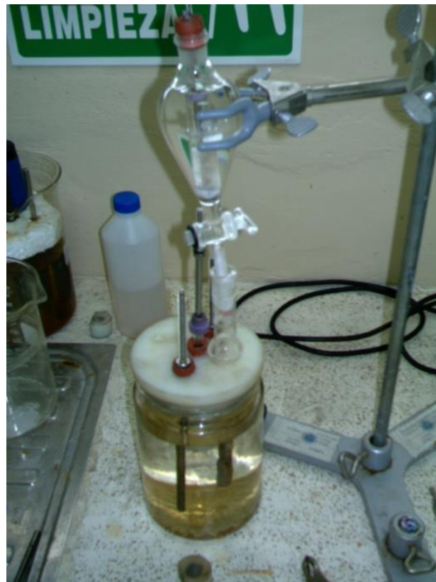
Figura 2.8 Celda de Polarización Electroquímica (Diseño Terminado).
