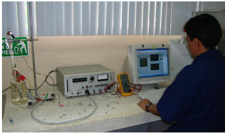
Figura 2.12 Ensayo Electroquímico Realizado para el Acero ASTM A42.
