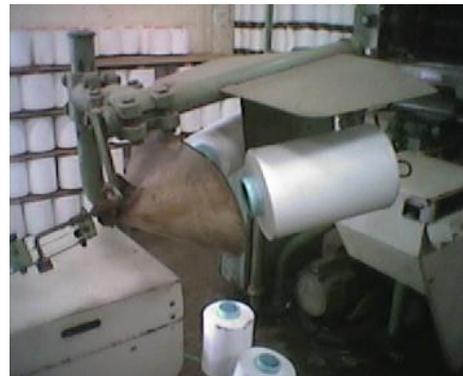
FIGURA 3.19. Bobina de trama en fileta.
