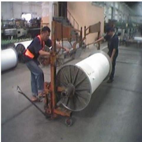
FIGURA 3.13. Carro Hidráulico.
