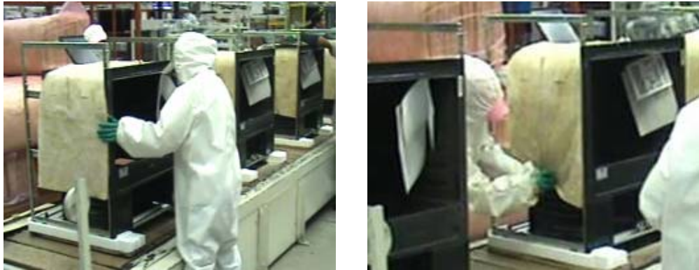
FIGURA 4.5 Y FIGURA 4.6, ESTACIÓN DE COLOCACIÓN Y SUJECCIÓN DE LANA DE VIDRIO
