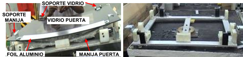
FIGURA 4.10 Y 4.11, SUB-ESTACIÓN VIDRIO PUERTA
