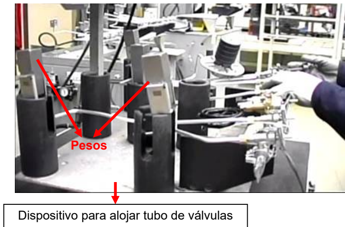
FIGURA 3.7 DISPOSITIVOS UTILIZADOS PARA REALIZAR LA PRUEBA DE FUGA DEL SISTEMA DE COMBUSTIÓN
