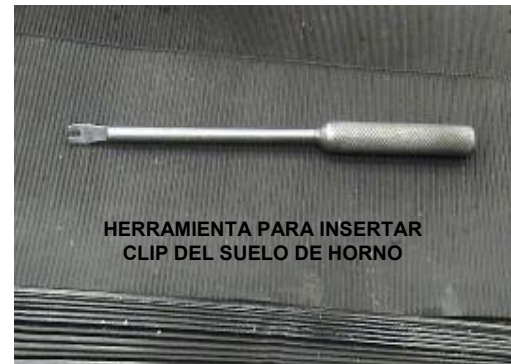
FIGURA 4.2 DISPOSITIVO DE ARMADO PARA ESPALDAR DE HORNO Y FIGURA 4.3 HERRAMIENTA PARA INSERTAR CLIPS PARA EL SUELO DE HORNO.
