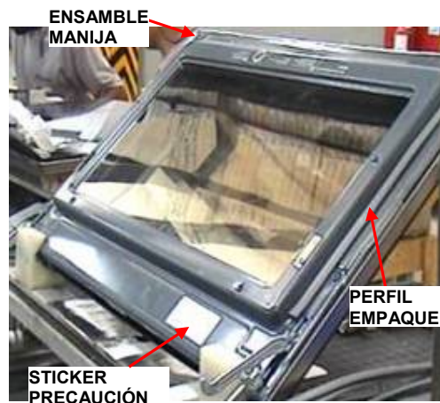
FIGURA 4.13, SUB-ESTACIÓN JALADERA Y PERFIL EMPAQUE
