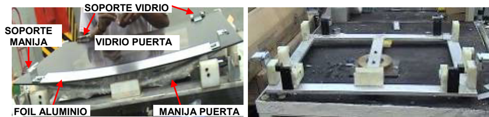
FIGURA 4.10 Y 4.11, SUB-ESTACIÓN VIDRIO PUERTA
