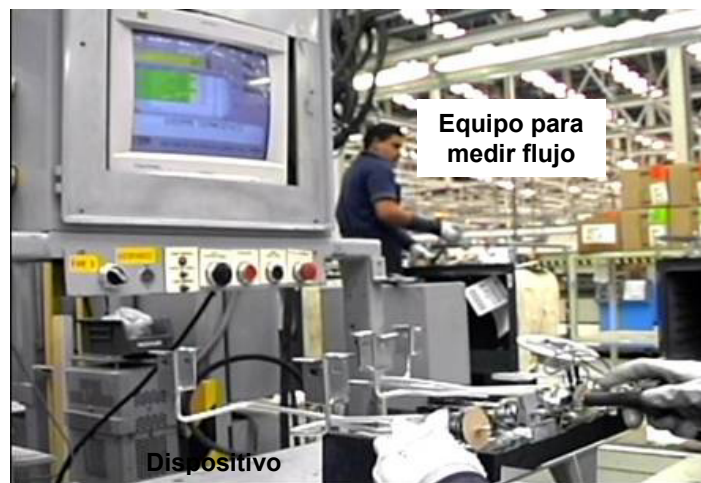
FIGURA 3.8 EQUIPO Y DISPOSITIVO UTILIZADO PARA REALIZAR PRUEBA DE FLUJO DEL SISTEMA DE COMBUSTIÓN
