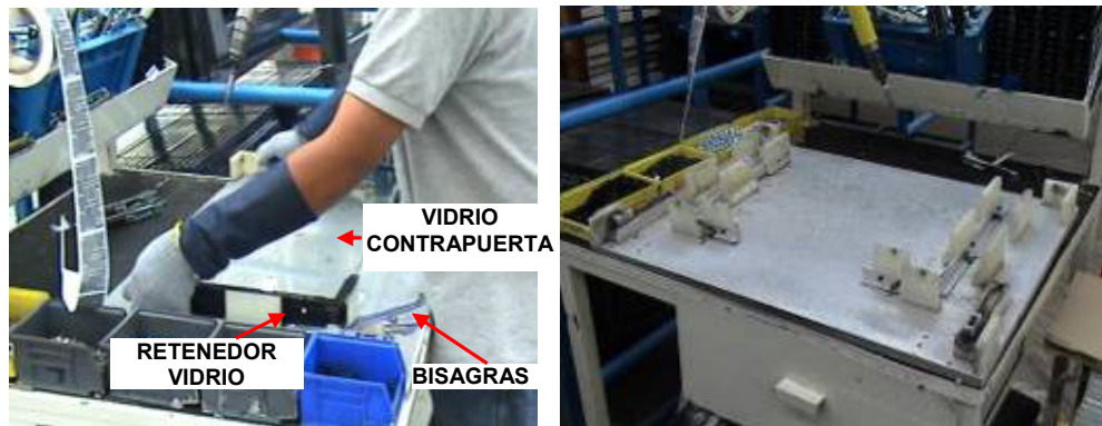
FIGURA 4.8 Y 4.9, SUB-ESTACIÓN CONTRAPUERTA DE HORNO
