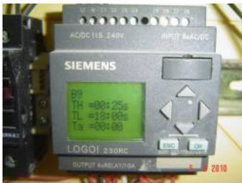
Entrada del Parámetro B9 al PLC
