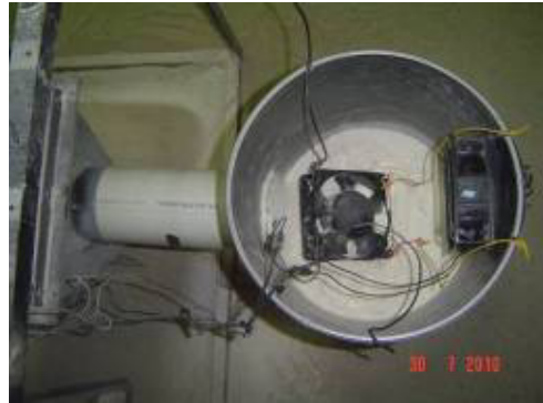
Tanque de Agitación y Ventiladores
