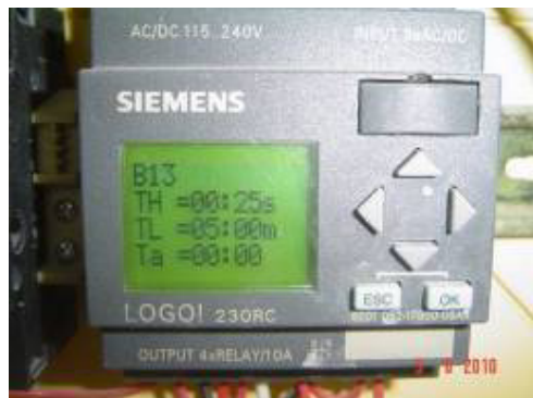
Entrada del Parámetro B13 al PLC
