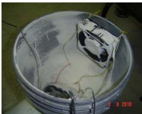
Ventiladores después de una Prueba
