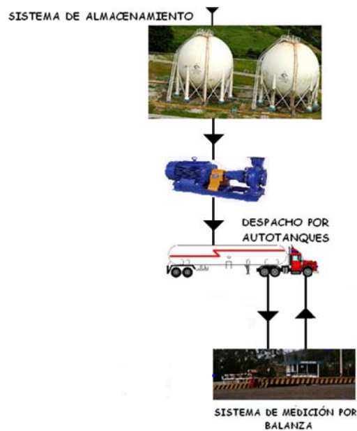
Figura 1. Diagrama de Proceso de Despacho de GLP
