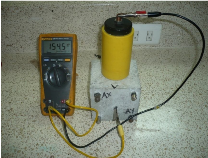
Fig. 4.- Medición de potencial contra el electrodo CSC
