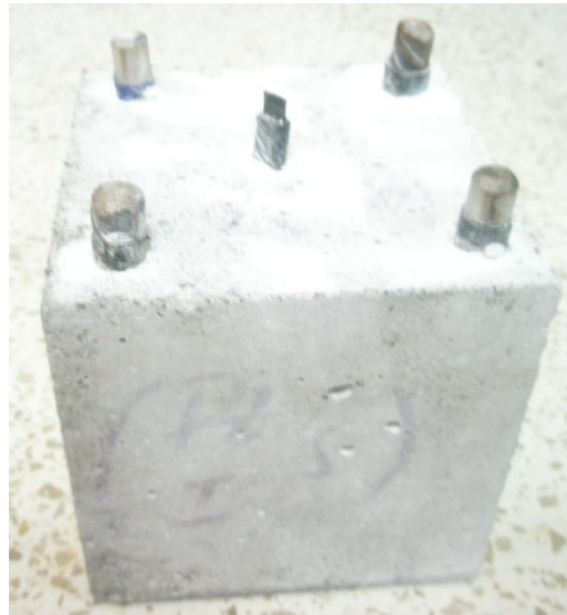
Fig. 13.- Probeta de hormigón armado terminada
