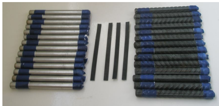
Fig. 8.- Barras de acero INOX 304 (izquierda), ASTM A-42 (derecha) y el ERI (electrodo de referencia interno) listas para ser empotradas en el cemento.
