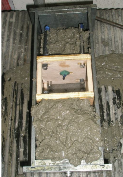
Fig. 11.- Molde en proceso de colado
