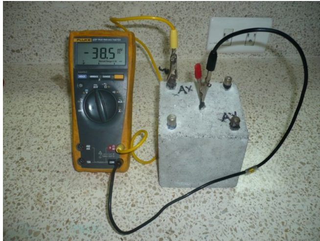
Fig. 3.- Medición de potencial con el electrodo de referencia interno ERI
