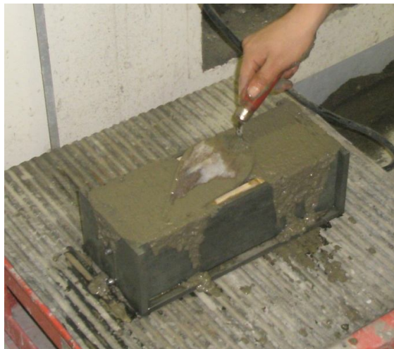
Fig. 12.- Probetas listas para el procesos de curado
