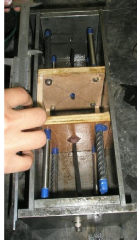
Fig. 10.- Molde listo para colada del cemento. Cada molde está preparado para colar dos probetas.
