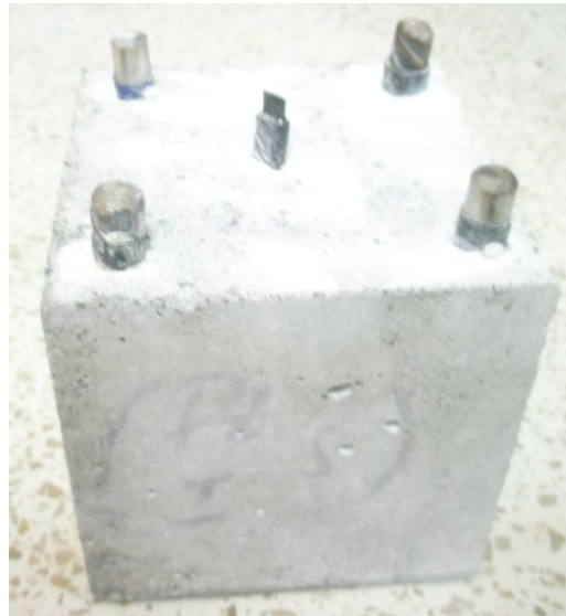
Fig. 13.- Probeta de hormigón armado terminada
