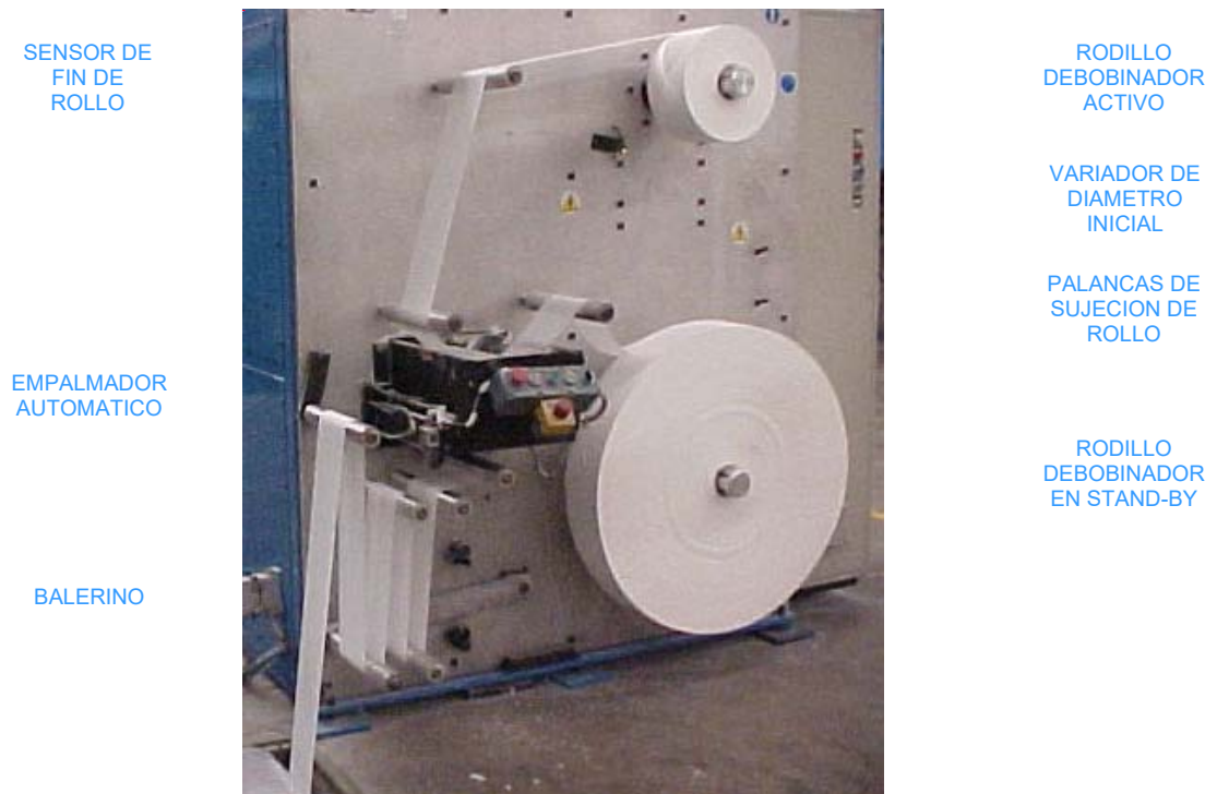
FIGURA 3.7 DEBOBINADOR TISSUE INFERIOR
