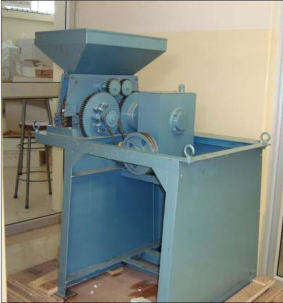
Máquina Briqueteadora a motor
