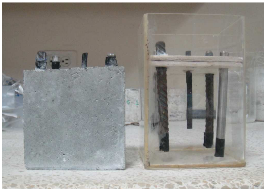
FIGURA 2.3 CELDA CONSTRUIDA CON LAS MISMAS PROPIEDADES QUE LAS DE HORMIGÓN
