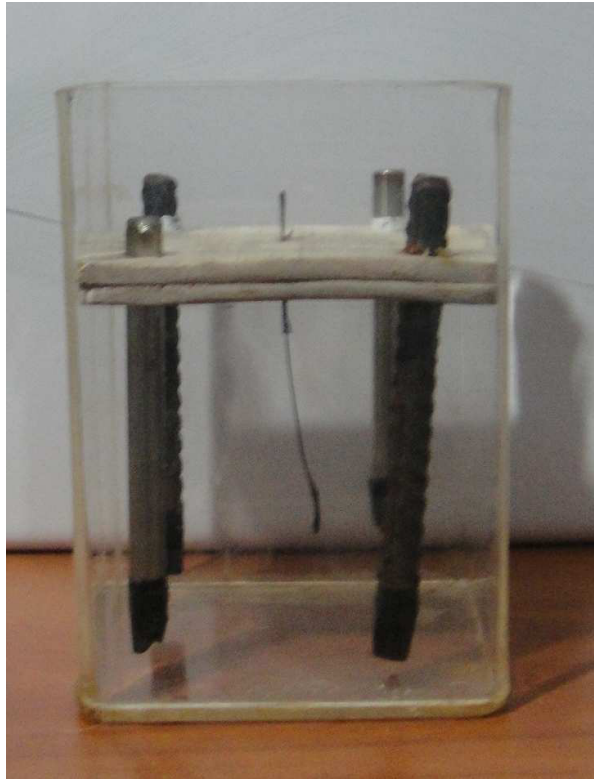
FIGURA 1.12 PROBETA CONSTRUIDA PARA EL CÁLCULO DEL FACTOR DE CELDA
