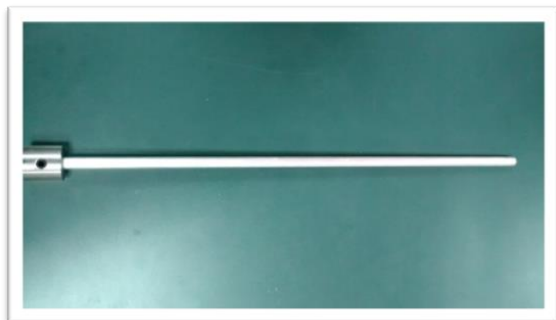
FIGURA 1.11. PÉNDULO CON PESO EN EL EXTREMO LIBRE
